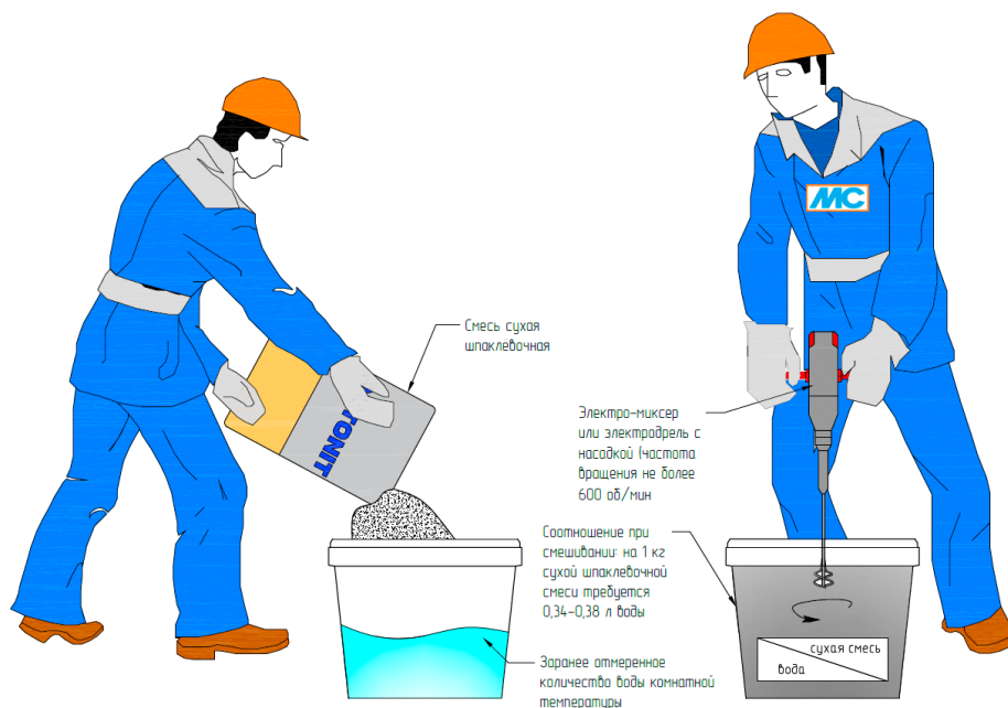
Рис. 30. Организация работ по затворению сухой шпаклевочной смеси
